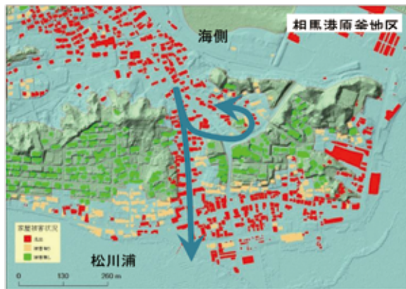
図 8 津波の浸水域と建物被害状況 及び被害特性検証図
