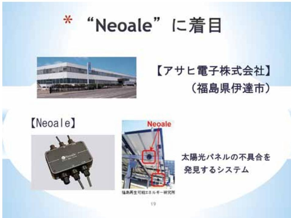
アサヒ電子株式会社の開発した「NEOALE (ネオエール)」は、直列回路 (ストリング) ごとの電流計測と1枚の太陽電離モジュールの電圧計測による、太陽光発電監視システムで、既設システムへの後付けが容易で、不良診断アルゴリズムによる故障診断が特長であり、他社の同様のシステムと比較し安価な設置が可能なシステムです。
